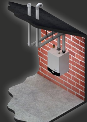
Ventilación vertical directa
