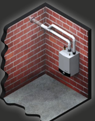
Ventilación directa concéntrica en pared lateral
