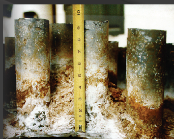
Tubes d'évacuation de fumée d'un réservoir d'eau traditionnel avec près de 6 po d'accumulation de calcaire
