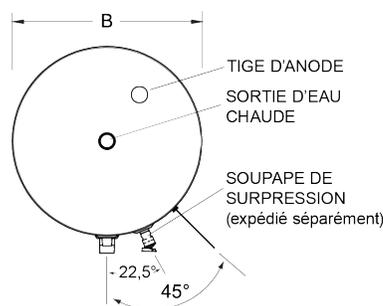
Le raccord « Sortie d'eau chaude » est femelle NPT.
