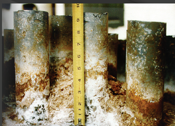
Tubos de gases de combustión de los calentadores de agua tradicionales tipo tanque con casi 6" de acumulación de incrustaciones de cal
