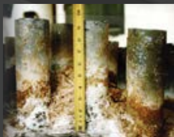
Tubes d'évacuation de fumée d'un ballon d'eau traditionnel avec près de 6 po d'accumulation de calcaire
