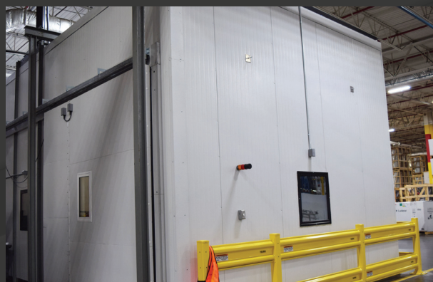
La température dans la chambre atmosphérique peut être réglée dans une plage allant de -20 °C (-5 °F) à 60 °C (140 °F)
