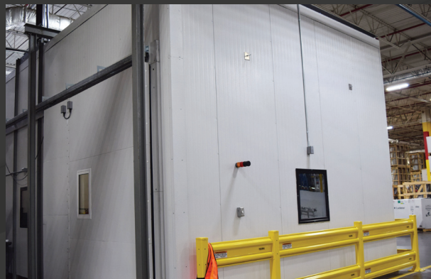
La cámara ambiental puede ajustarse con una temperatura de entre -5 °F y 140 °F (-20.5 °C y 60 °C)
