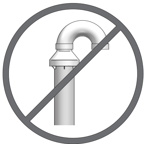
Figure 5-5 Ne jamais ajouter un raccord en "U" au chapeau de pluie
