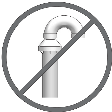
Figure 5-5 N'attachez pas de coude en U au capuchon anti-pluie.
