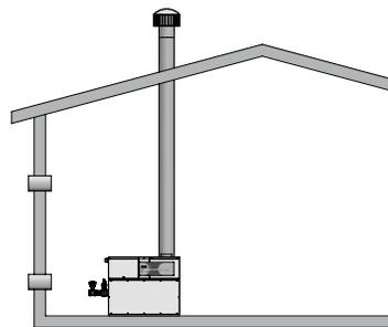
Figure 1-3\_Air extérieur de combustion - Deux ouvertures
