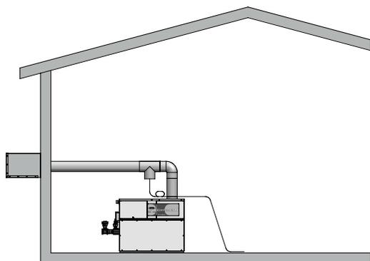
Figure 2-9\_Ventilation de paroi latérale - Modèles 402 - 752 (Uniquement)
