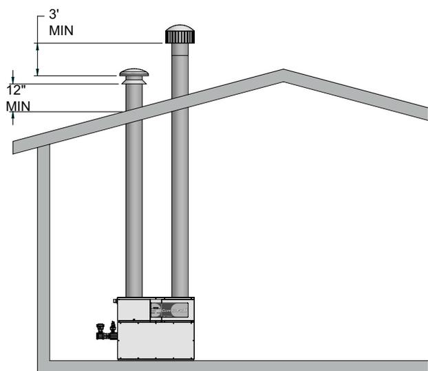
Figure 2-7\_Entrée d'air de combustion par le toit
