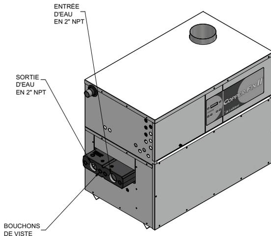
Figure 4-1\_Raccordements d'eau - Modèle 402 - 752
