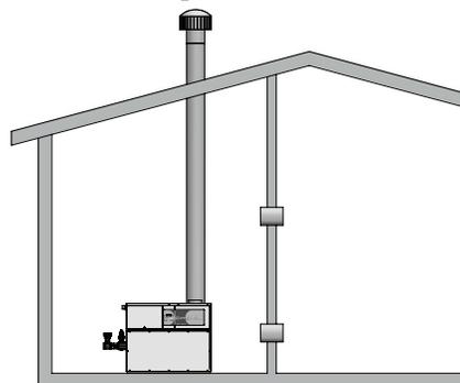
Figure 1-4\_Air de combustion de l'espace intérieur
