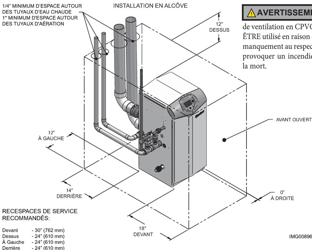
**AVERTISSEMENT** Pour les installations en alcôve, un matériau de ventilation en CPVC ou en acier inoxydable DOIT ÊTRE utilisé en raison des températures élevées. Tout manquement au respect de cet avertissement pourrait provoquer un incendie, des blessures corporelles ou la mort.
