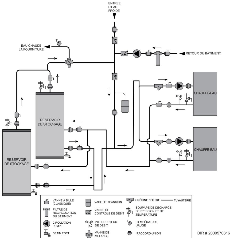
**ATTENTION** La tuyauterie ne supporte pas le poids de la pompe du circulateur du chauffe-eau. Ne pas essayer de faire soutenir le poids de la pompe du circulateur du chauffe-eau par la tuyauterie ou ses accessoires. Se référer aux instructions d'installation du fabricant de la pompe. Sinon, de graves blessures personnelles, la mort ou des dégâts matériels importants pourraient en résulter.
