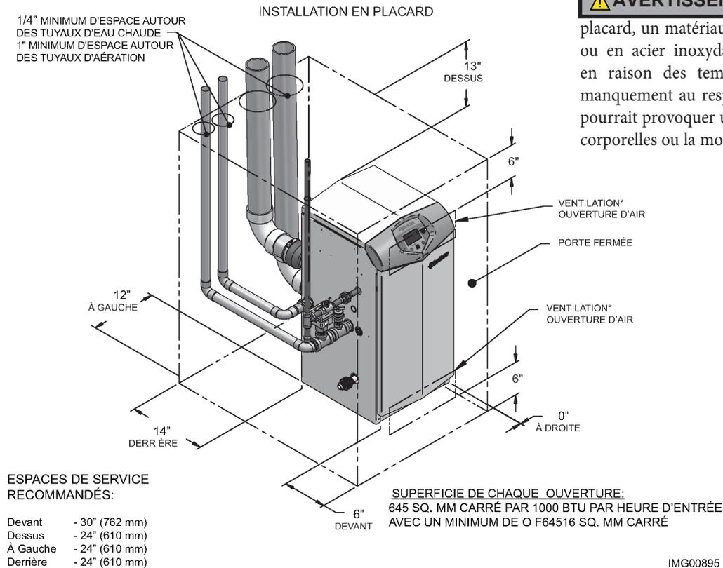
**AVERTISSEMENT** Pour les installations en placard, un matériau de ventilation en CPVC ou en acier inoxydable DOIT ÊTRE utilisé en raison des températures élevées. Tout manquement au respect de cet avertissement pourrait provoquer un incendie, des blessures corporelles ou la mort.
