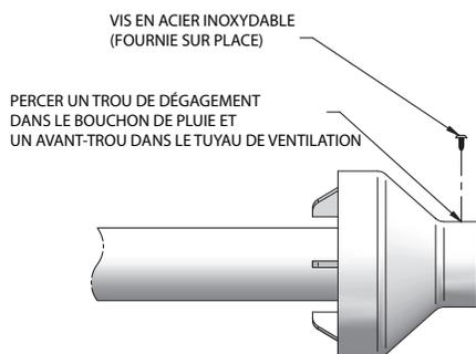
**Figure 4-11** Schéma des dimensions de ventilation concentrique - Modèles 286
