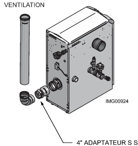
**Tableau 3G** Tuyau et raccords de ventilation en acier inoxydable
