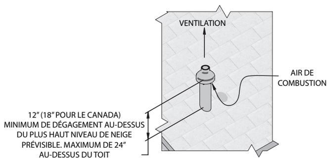
**AVIS** Au lieu de coller le plus petit tuyau au bouchon de pluie, une vis en acier inoxydable fournie sur place peut être utilisée pour assembler les deux (2) composants lorsqu'il est nécessaire de les démonter sur place pour le nettoyage (voir FIG. 4-12, page 29).
