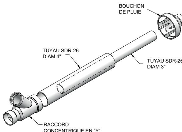
Figure 4-9 Contenu du kit\_100140484 - Modèle 286
