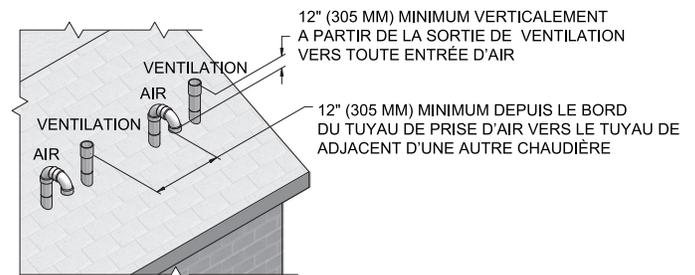
**Figure 5-3** Terminaisons verticales alternatives avec chaudières multiples
