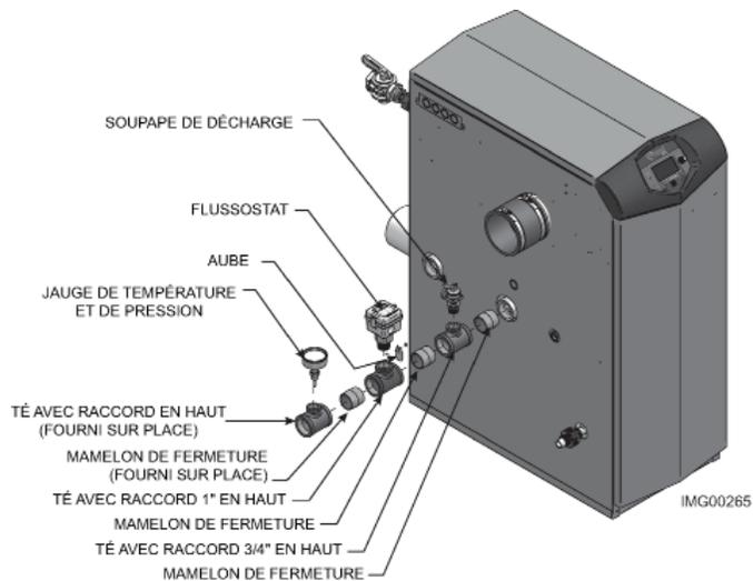
**Figure 6-2** Pose du flussostat, de la soupape de décharge et de la jauge de température et de pression\_Modèles 601 – 801
