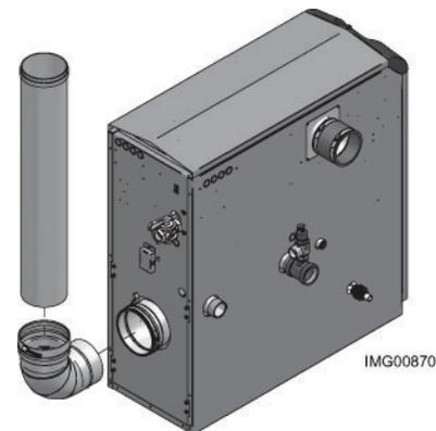
\*La ventilation murale intérieure lisse FasNSeal Flex ne s'utilise que dans les parties verticales ou presque verticales, en prenant soin de s'assurer qu'aucun affaissement ne se produit sur le circuit de ventilation. Raccorder à la ventilation rigide FasNSeal à l'aide d'adaptateurs spécialement conçus et selon la méthode de collage, voir les instructions du fabricant.
