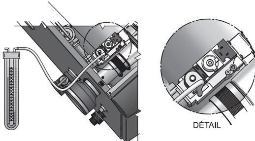
**Figure 7-6** Vérification de l'alimentation en gaz d'entrée - Modèle 501
