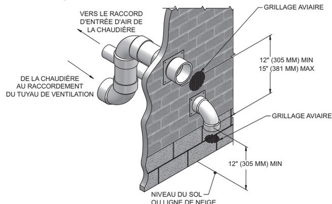
**Figure 4-2B** Autres modèles de terminaison murale en SS 701 - 801 avec raccords fournis sur place
