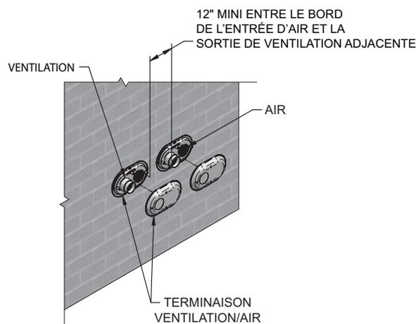
**Figure 4-6B Terminaisons de ventilation multiple alternatives (doivent également être conformes à la Figure 4-1B)**
