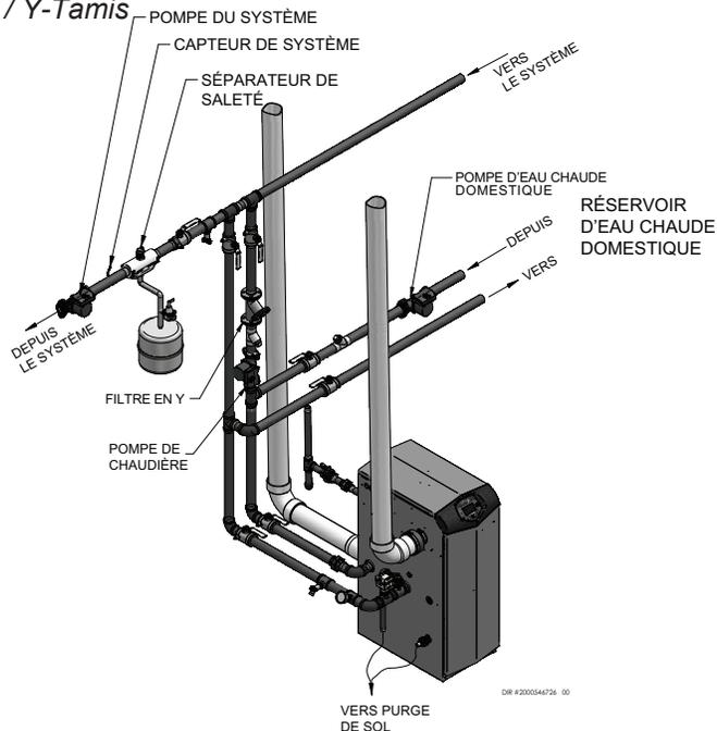
Figure 6-4B Tuyauterie à proximité de la chaudière avec collecteur à faible perte
