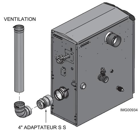
**Figure 3-7** Près de la ventilation en acier inoxydable de la chaudière modèles 701 - 801
