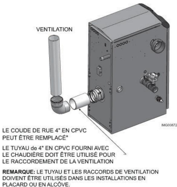
5. Sécher le tuyau de ventilation ou d'air pour permettre un bon raccordement avant de coller l'ensemble. Le tuyau doit rentrer de un à deux tiers dans le raccord pour permettre une bonne étanchéité après avoir mis la colle.
