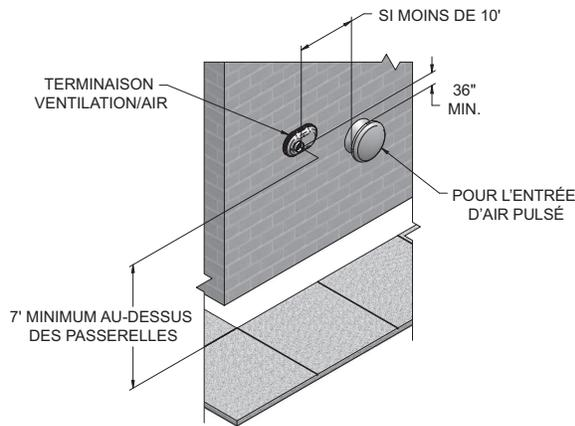
**Figure 4-4B** Espace alternatif pour les entrées d'air pulsé avec raccords fournis sur place
