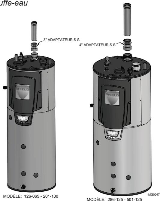
\*La ventilation murale intérieur lisse FasNSeal Flex ne s'utilise que dans les parties verticales ou presque verticales, en prenant soin de s'assurer qu'aucun affaissement ne se produit sur le circuit de ventilation. Raccorder à la ventilation rigide FasNSeal à l'aide d'adaptateurs spécialement conçus et selon la méthode de collage, voir les instructions du fabricant.
