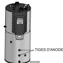
**AVIS** Les tiges d'anode qui montrent une décomposition excessive peuvent indiquer une électrolyse. Une masse doit être raccordée au récipient pour dévier le courant de fuite et éviter d'endommager le réservoir.
