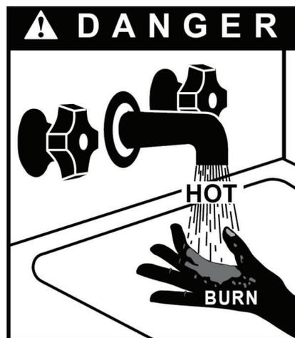
Une température d'eau supérieure à 125° F (52°C) peut provoquer instantanément de graves brûlures ou la mort.
