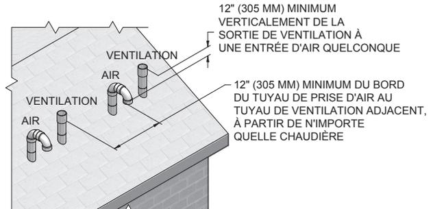
**Figure 5-4** Autres terminaisons verticales avec plusieurs chauffe-eau
