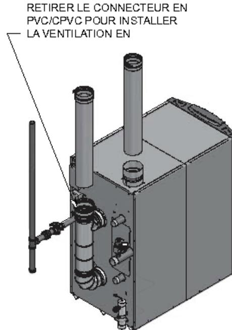
Le Armor X2 utilise une prise d'air de combustion et des tailles de tuyauterie de ventilation spécifiques du modèle et détaillées aux Tableaux 3A et 3B.
