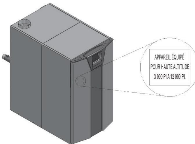
Figure A Emplacement de l'étiquette haute altitude
