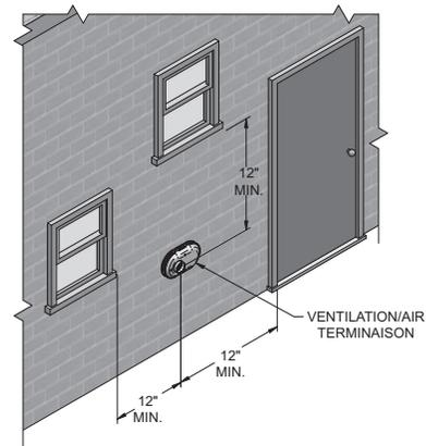
**Figure 4-2B** Espace alternatif par rapport aux entrées d'air gravitaires avec raccords fournis sur place
