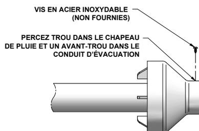
6. Insérez le raccord concentrique en Y et les conduits dans le perçage mural.
